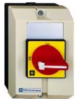
Fig. 14 - Interrupteur-sectionneur principal et d'arrêt d'urgence Vario en coffret VCF OGE de chez Schneider (poignée : rouge cadénassable par 3 cadenas ; Ithe : 20 A ; puissance AC-23 à 400 V : 7,5 kW).
