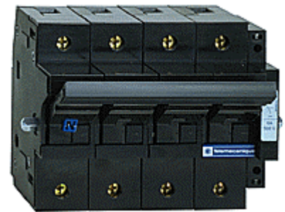
Fig. 14 - Sectionneur tétrapolaire GK1-EM (calibre : 50 A ; taille des cartouches fusibles : 14 X 51 ; 1 contact auxiliaire de pré coupure).
