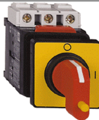
Fig. 3 - Interrupteur-sectionneur principal et d'arrêt d'urgence tripolaire avec poignée rouge cadenassable 32 A (VVE 1 Schneider).
