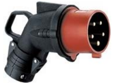
Fig. 9 - Fiche : BT 32 A ; IP 44 ; 380/415 V ~ ; 3P + N + T. (528 44 Legrand)
