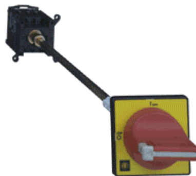
Fig. 21 - Dispositif de commande VCCDN 20 (poignée : rouge cadenassable par 3 cadenas ; plastron : jaune 60 X 60 mm ; I_{th} = 20\text{ A} ).
