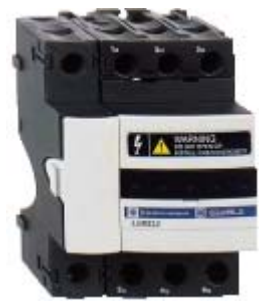
Fig. 13 - Sectionneur tétrapolaire LS1 D32 + LA8 D324 (calibre : 32 A ; taille des cartouches fusibles : 10 X 38).
