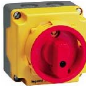
Fig. 8 - Coffret de proximité 12 A pour coupure/sectionnement d'un moteur 1 vitesse : 3 pôles ; IK 08. (226 60 Legrand)
