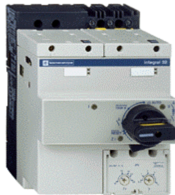
Fig. 23 - Contacteur-disjoncteur et inverseur Integral 32 LD5 LC030B + module de protection magnéto-thermique (sectionnement, isolement et consignation par pôles spécifiques).
